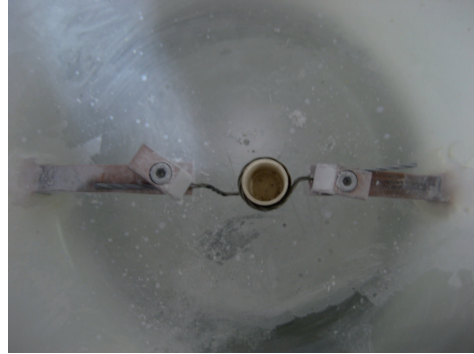
Abbildung 5.6: Zustand in der Verdampfungskapsel nach schneller Verdampfung.
